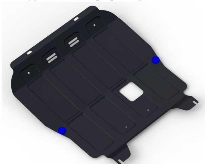
Termoplastdan olingan Nexia R3 avtomobil dvigateli va uzatmalar qutisi uchun himoya moslamasi
