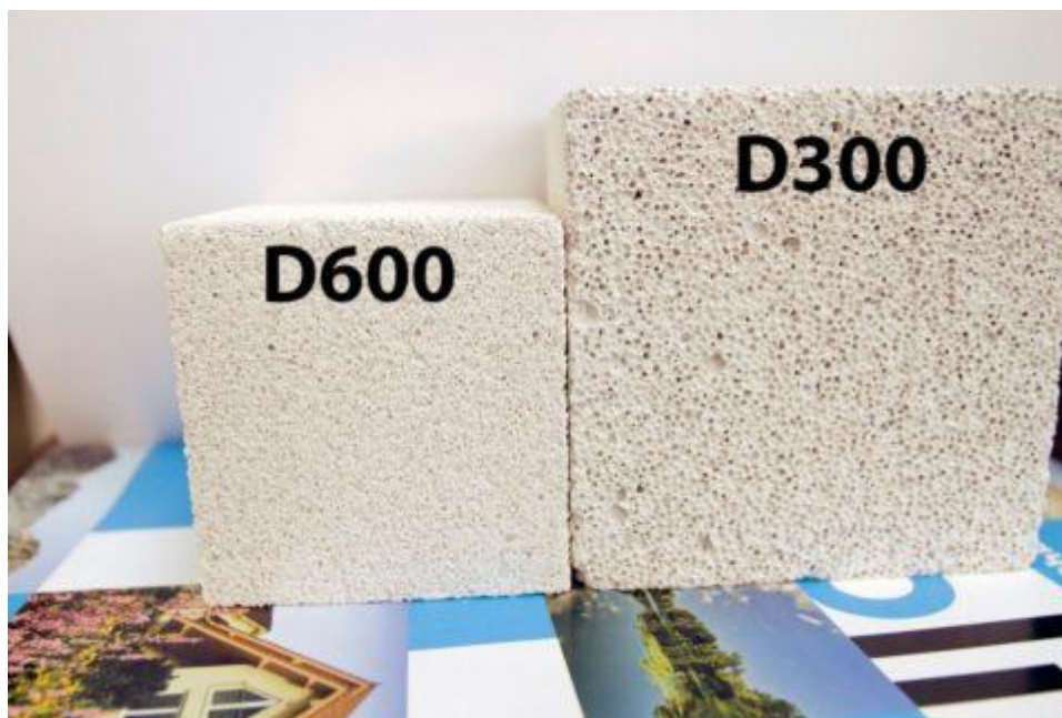
1-rasm. Turli o'rtacha zichlikdagi bloklar, fotosurat Geometrik og'ishlar uchun KMK 2.01.04-2018
