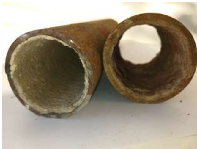
1-rasm. Issiqlik almashinish qurilmasining ichki qismida quyqalar bilan ifloslanib, tiqilib qolgan trubaning bir qismi
