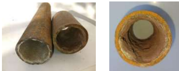
1-rasm. Issiqlik almashinish qurilmasining ichki qismidan kesib olingan quyqali namuna trubasi
