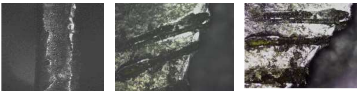
6-rasm. Mavjud arracha segmentni tayyorlash texnologiyasidan xosil bolgan nuqsonlar
