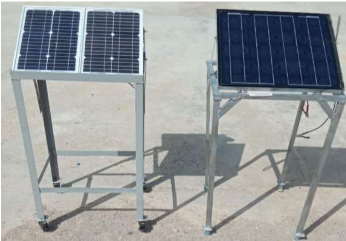
1-rasm. Orqa himoya qatlami oq va qora rangda bo'lgan monokristall kremniyli fotoelektrik batareyalar quyoshning zenit nuqtasidagi burchagiga o'rnatib elektr parametrlarini taqqoslash
