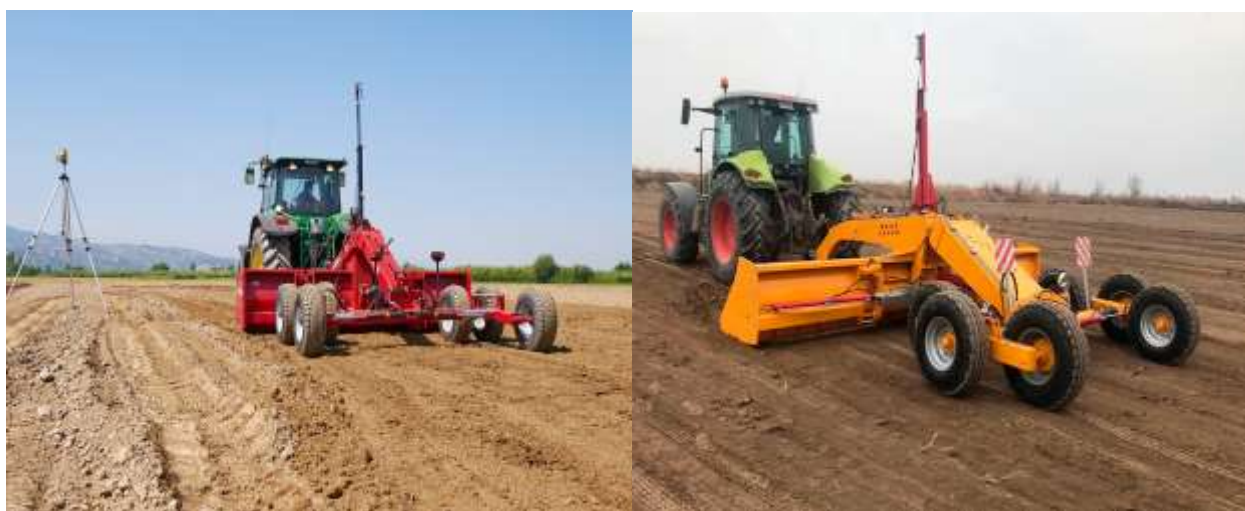
1-rasm. Lazerli yer tekislash agrotexnologiyasi. Ongda PL-5 Lazer boshqaruvli yer tekislagich.
