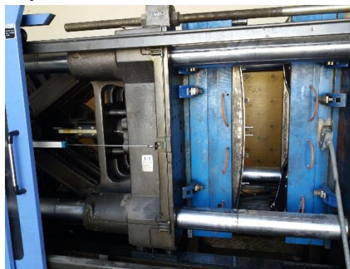
Himoya qoplamasi uchun termoplast qolip
