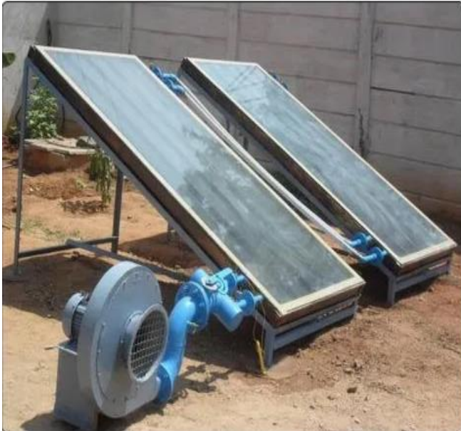
7-rasm. Quyosh havo isitgich kollektorining umumiy ko'rinishi
