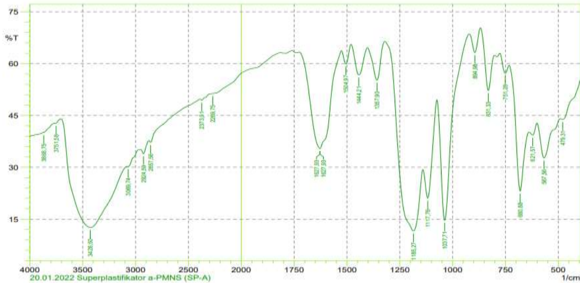
6-расм. Чизикли полиметиленигнин сулфонат натрийнинг ИҚ-спектри
