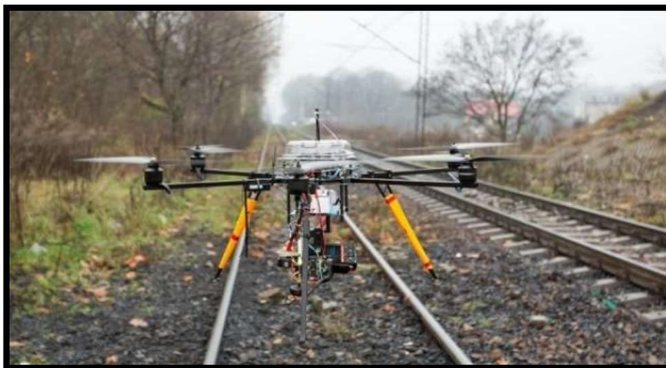
**Рис.2. БПЛА квадрокоптеры с камерой.**
