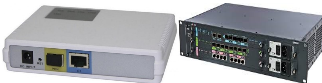
Рис.4. Оборудование OLT и ONT
