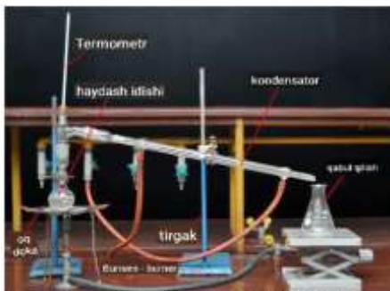
2 – rasm. Aralashmalarni ajratishning haydash (Haydash usuli) jarayoni.
