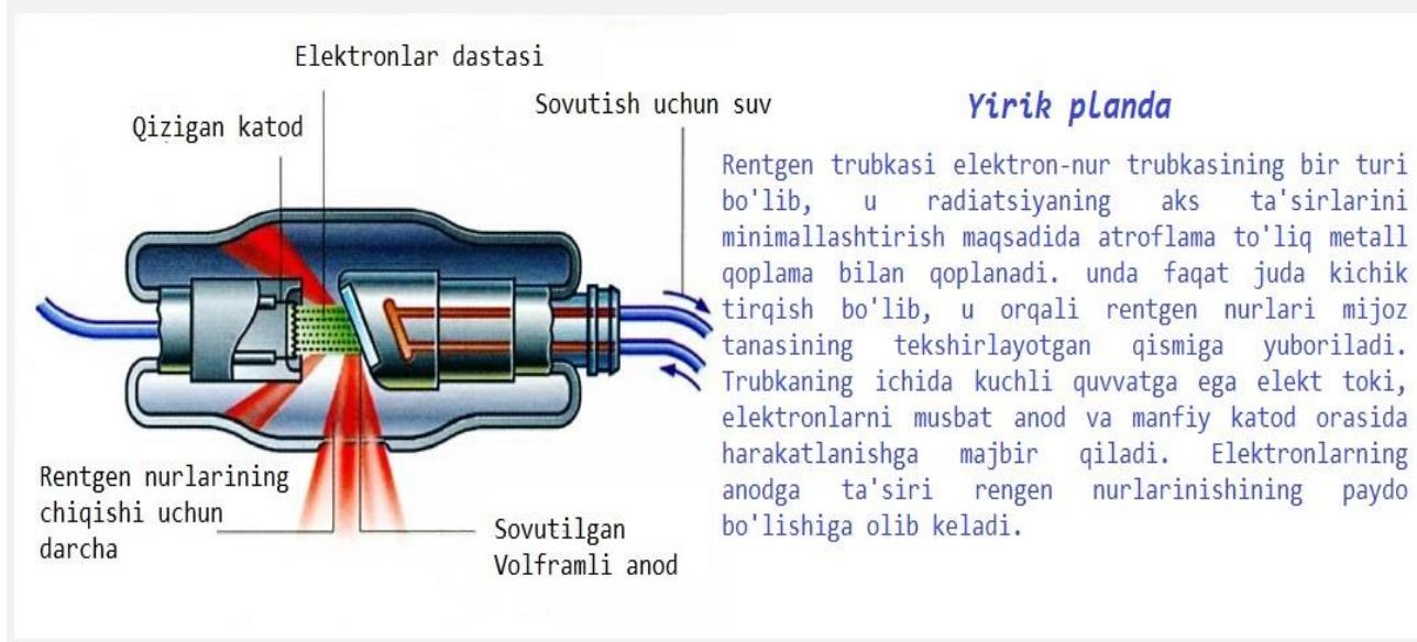
Рентген трубкаси электрон-нур трубкасининг бир тури бўлиб, у радиациянинг акс таъсирларини минималлаштириш мақсадида атрофлама тўлиқ металл қоплама билан қопланади. Унда фақат жуда кичик тирқиш бўлиб, у орқали рентген нурлари mijoz танасининг текширлаётган қисмига юборилади. Трубканинг ичидаги кучли қувватга эга электр токи, электронларни мусбат анод ва манфий катод орасида ҳаракатланишга мажбур қиласида. Электронларнинг анодга таъсири рентген нурларинишининг пайдо бўлишига олиб келади.
