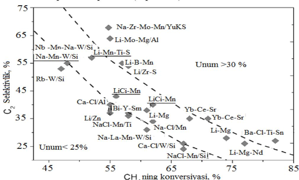
1-расм.  $\text{C}_2$  –углеводородлар унуми  $\text{C}_2 \geq 25\%$  бўлган МОК реакцияси катализаторлари. Барча катализаторлар  $700 \div 900^{\circ}\text{C}$  да  $\text{CH}_4/\text{O}_2 = 2 \div 8$  нисбатда, одатдаги атмосфера босимида синалган
