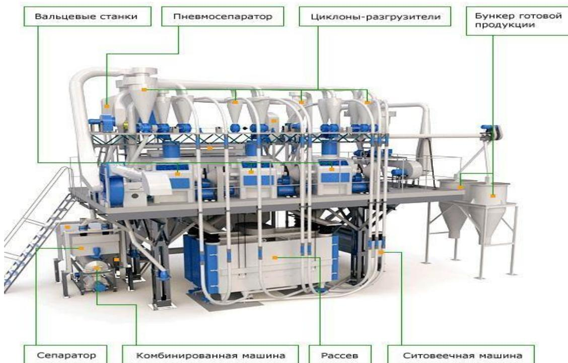
**Рисунок 1. Оборудование современной мельницы**
