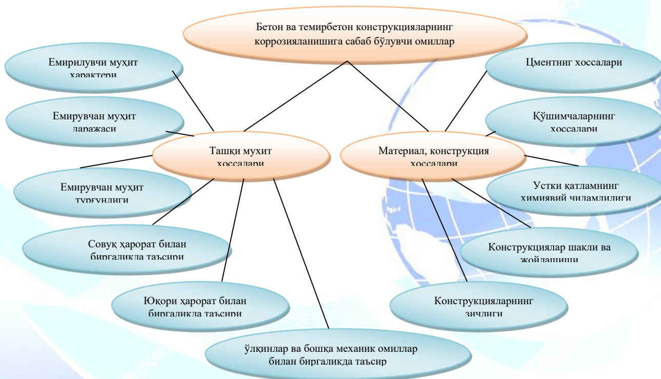
2-расм. Бетон ва темирбетон конструкциялар коррозияланишининг таснифланиши
