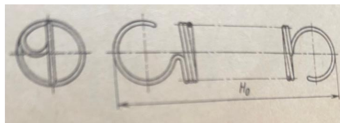
Рис. 2. Схема пружины параллелограммной подвески: H_0 – длина
