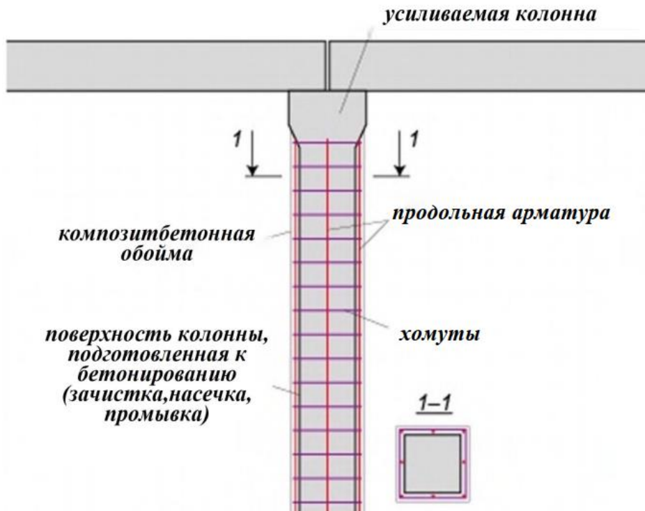
Рис. 1. Конструктивная схема и схема устройства композитбетонной обоймы усиления колонны
