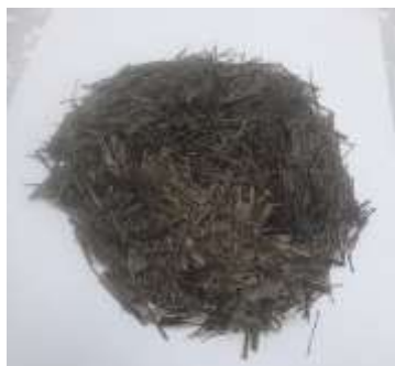
Рис.1. Базальтовые волокна, использованные в экспериментах
