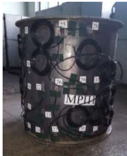
1-rasm. Xarakterli nuqtalariga tenzorezistorlar o'rnatilib sinaShga tayyorlangan kuchaytirilmagan silliq devorli qobiq modeli
