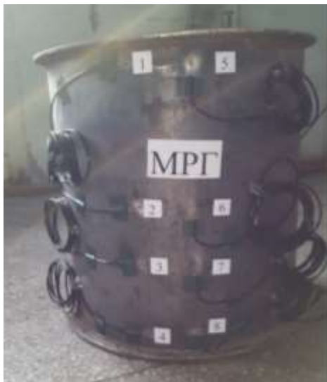
1-rasm. Xarakterli nuqtalariga tenzorezistorlar o'rnatilib sinaShga tayyorlangan kuchaytirilmagan silliq devorli qobiq modeli
