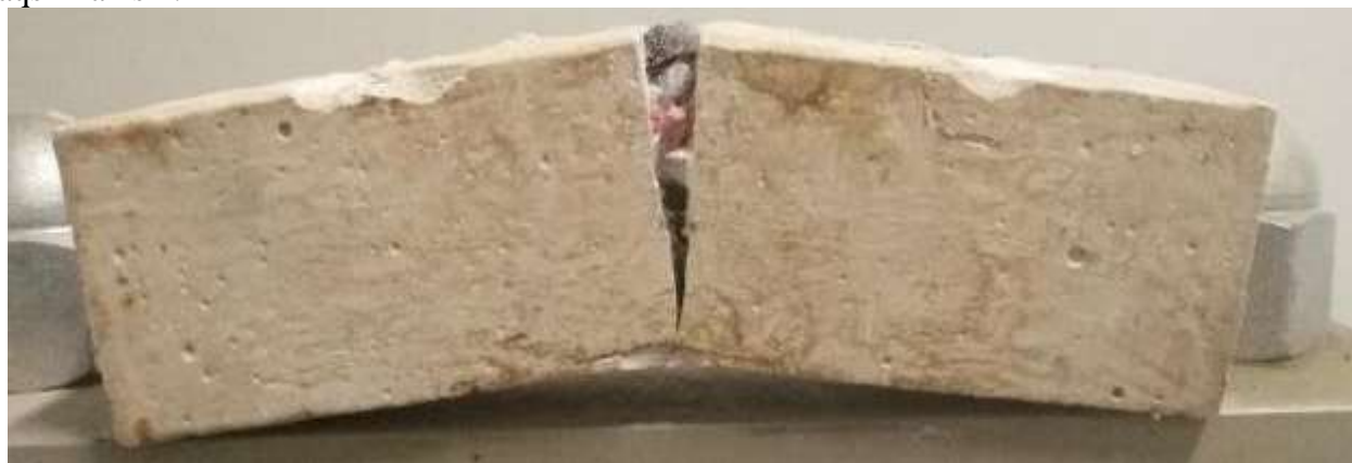
9-rasm Egilishga sinalgan gipsa blok.
