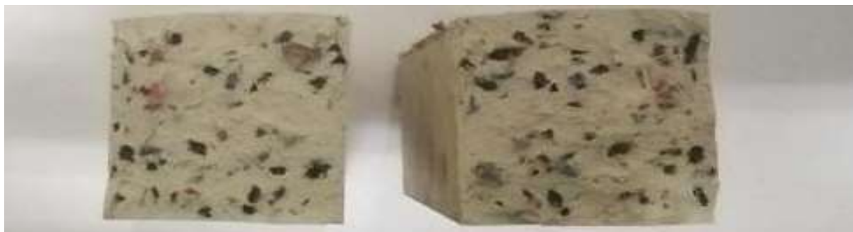
8-rasm. Gips blokiga poyafzal va mato sanoatidagi chiqindilari va quyqimlari qoldiqlarini taqsimlanishi.
