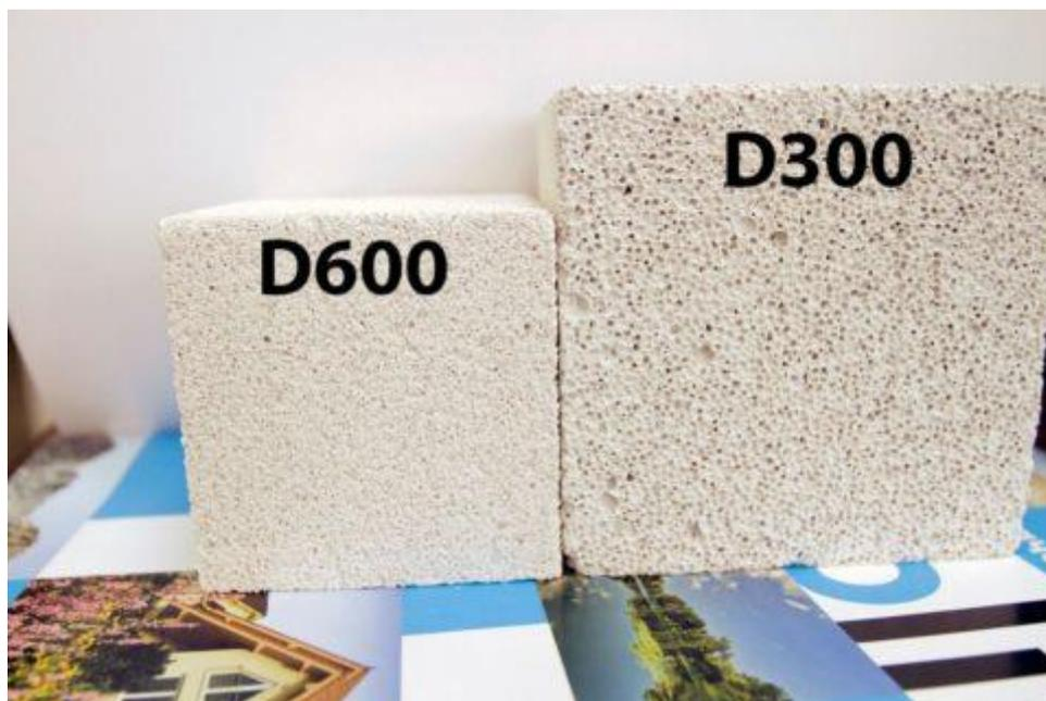
Рис.1 Блоки с разным показателем средней плотности, фото
