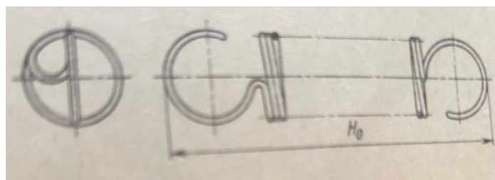
Рис. 2. Схема пружины параллелограммной подвески: H_0 – длина
