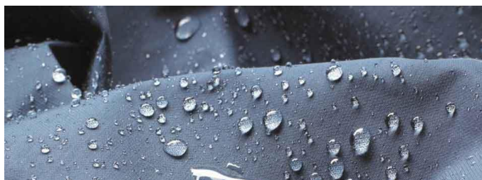
4-rasm. Suv o'tkazmaydigan va nafas oladigan mato
