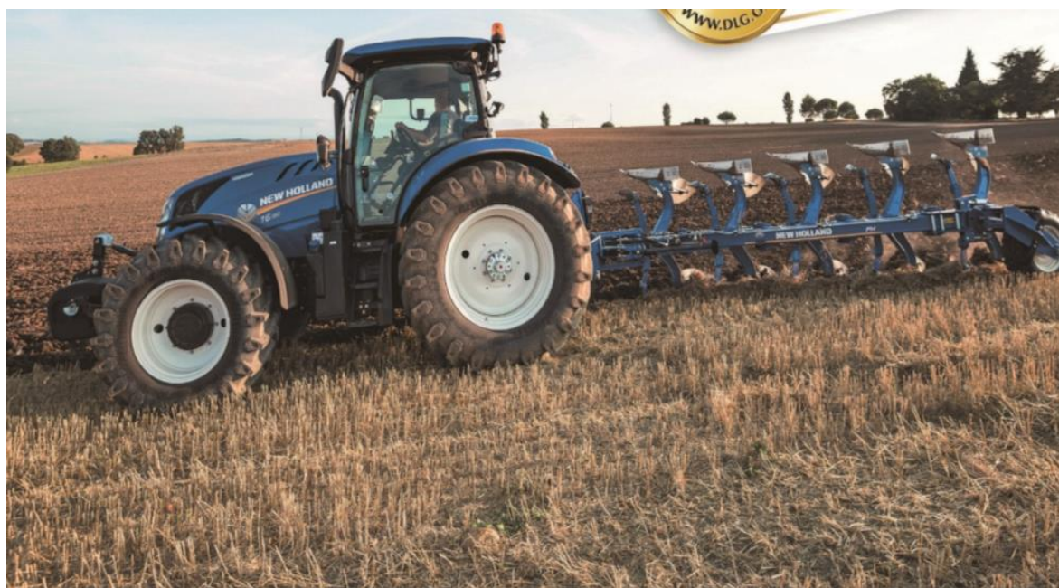
Рисунок 1. Испытания в DLG трактора NEW HOLLAND T6.180 с шести корпусным оборотным плугом.
