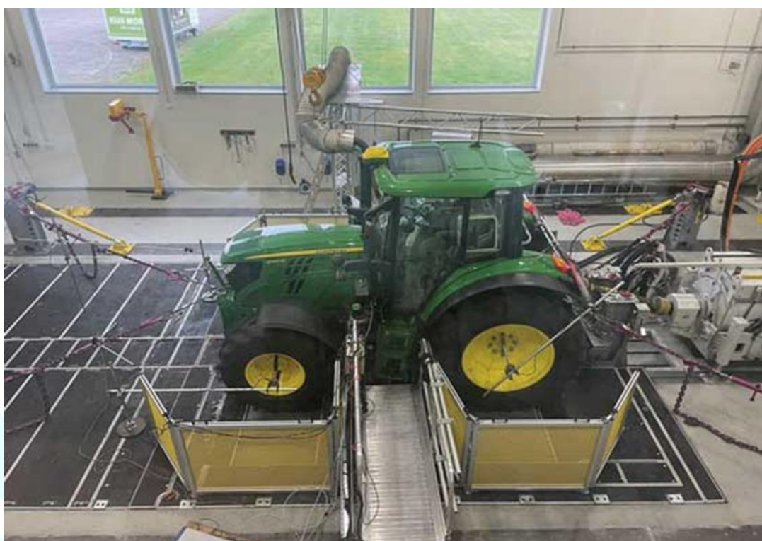
Рисунок 3. Испытательный центр DLG. Стендовые испытания трактора John Deere серии 6B.
