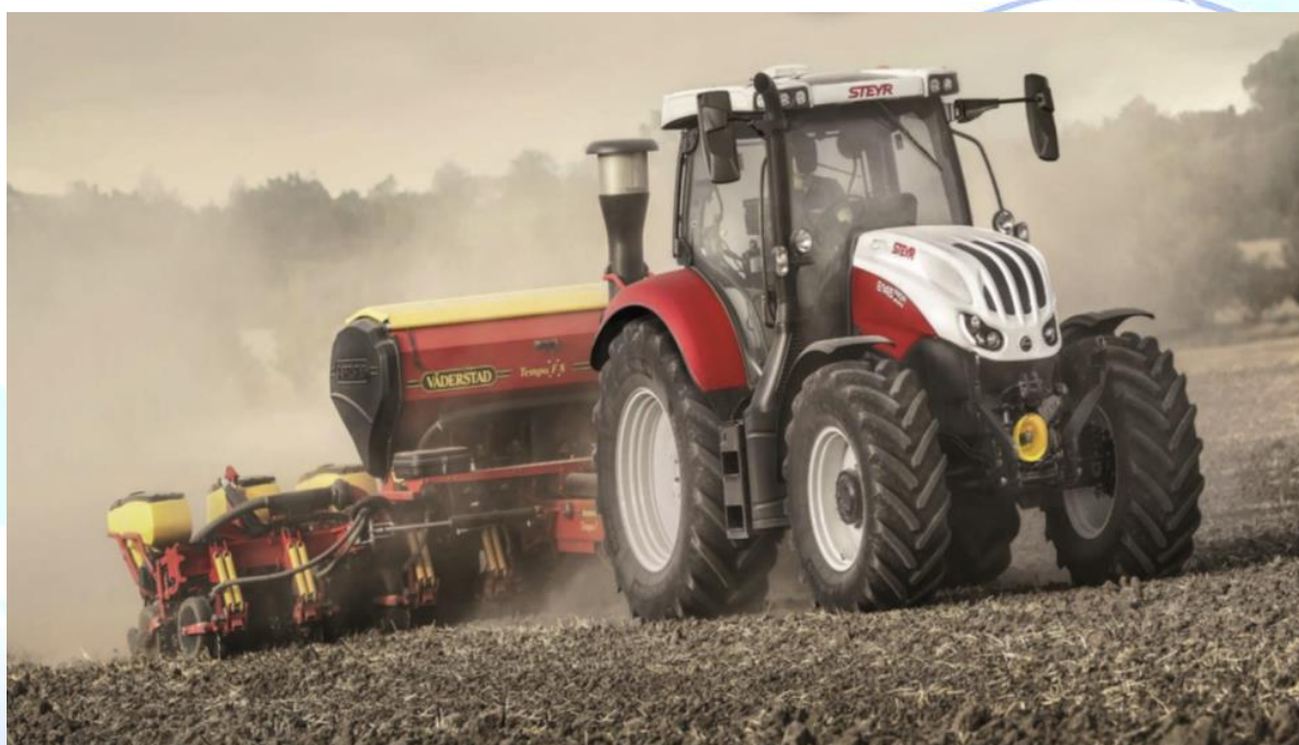
Рисунок 2. Испытания в DLG трактора Steyr Profi 6145 S с сеялкой на посеве кукурузы
