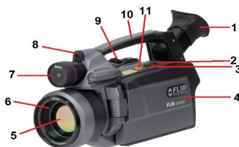
Рис -3. Показано общий вид селективного тепловизоров .Профессиональный тепловизор FLIR P660 для систем непрерывного контроля и мониторинга и изображено 1-видео искатель.2-кнопка Right 3-кнопка Left.4- 5 дюймовый сенсорный экран.6-крышка объектива.7-лазерный активатор8-лазерный указатель9-ручка фокусирования объектива.10-ручной держатель прибора.11- меню управления.
